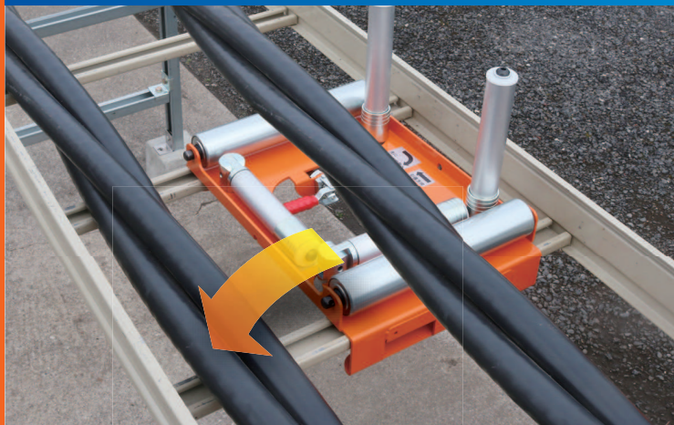
垂直ローラーを倒すことで延線したケーブルをラック上に簡単に落とせる
